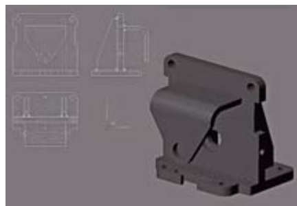
Mit iQMechanical lassen sich aus 2D-Zeichnungen einfach und schnell 3D-Modelle erzeugen
